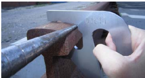
Figur 11.6 - Placering af målekegle til måling af sideslid.
