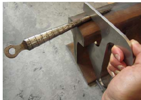
Figur 11.5- Placering af målekegle til måling af højdeslid.
