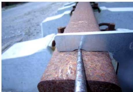
Figur 11.4 - Placering af målekegle til måling af højdeslid.
