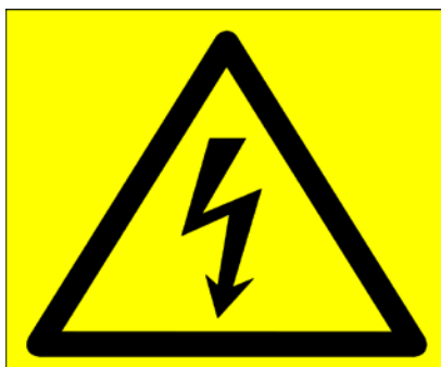
Figur 11.1.8.2-3 Advarselstavle for farligt elektrisk område.
