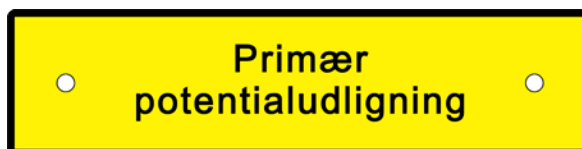
Figur 10.4.3-1 Skilt for primær potentialudligning.
