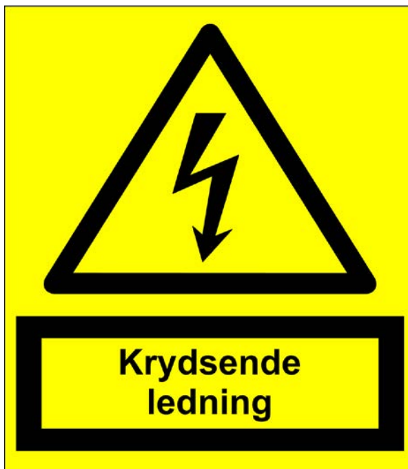
Figur 11.1.8.2-5 Advarselstavle for krydsende ledning.
