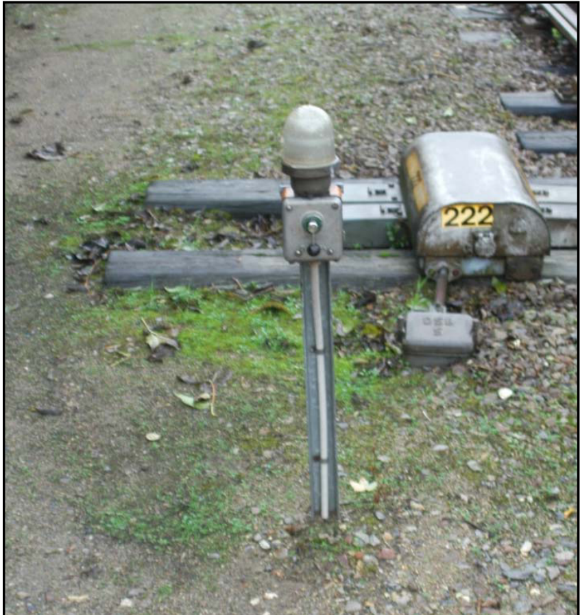
Centralaflåst sporskifte med el-stedbetjening
