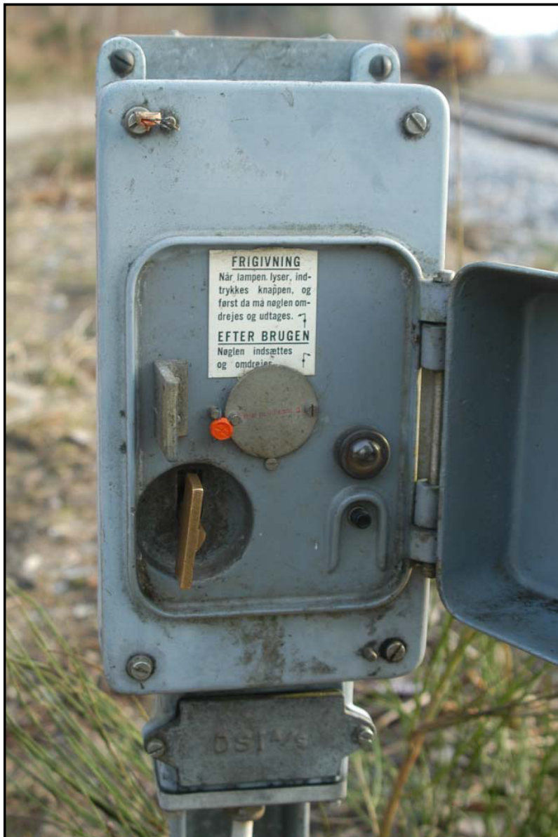
Skab med hovednøgle til elektromagnetisk nøgleaflåst sporskifte
