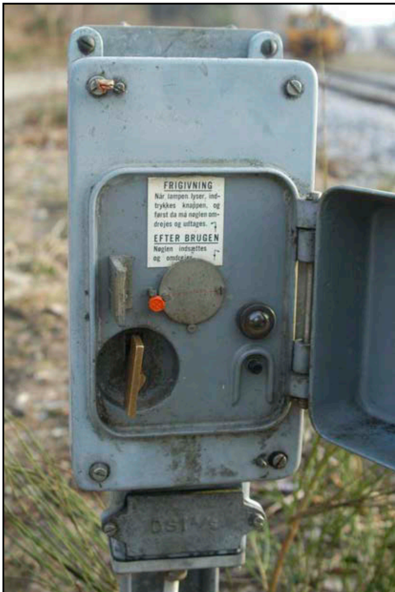
Skab med hovednøgle til elektromagnetisk nøgleaflåst sporskifte
