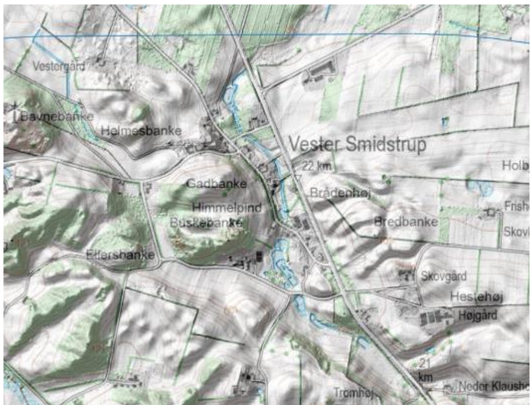
Figur 42. Illustration af højdemodel og topografisk kort /6/. Vester Smidstrup er beliggende i et markant randmorænelandskab (Blå streg: Gadbjerg delstrækning).
