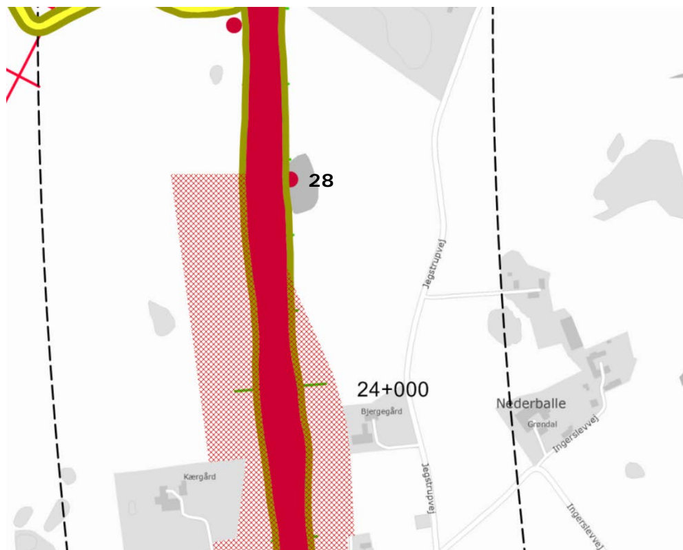
Figur 14. Anlægsarbejde ved fokusareal nr. 28 ved Østlig linjeføring, markeret med rød prik. Permanent areal er markeret mørk rød, mens midlertidigt areal er markeret olivengrøn. Gul markerer kommende offentlig vej. Rødskraverede arealer markerer områder, hvor der kan udlægges overskudsjord.
