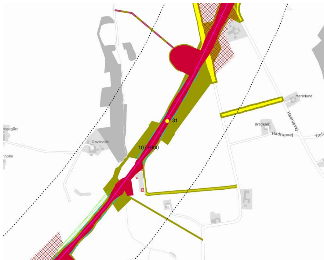
Figur 15. Anlægsarbejde ved fokusareal nr. 31 ved Sydøstligt alternativ, markeret med rød prik. Permanent areal er markeret mørk rød, mens midlertidigt areal er markeret olivengrøn. Gul markerer kommende offentlig vej. Rødskraverede arealer markerer områder, hvor der kan genindbygges overskudsjord.
