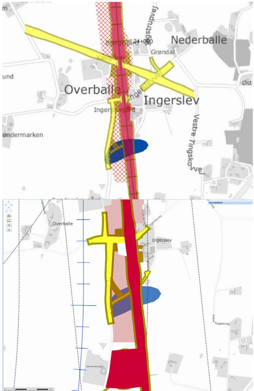
Figur 12. Anlægsarbejde på lokalitet 751-07312 ved Østlig linjeføring. Blå = V1, mørk rød er permanente arealer, mens olivengrøn er midlertidige arbejdsarealer. Gul er kommende offentlig vej.
