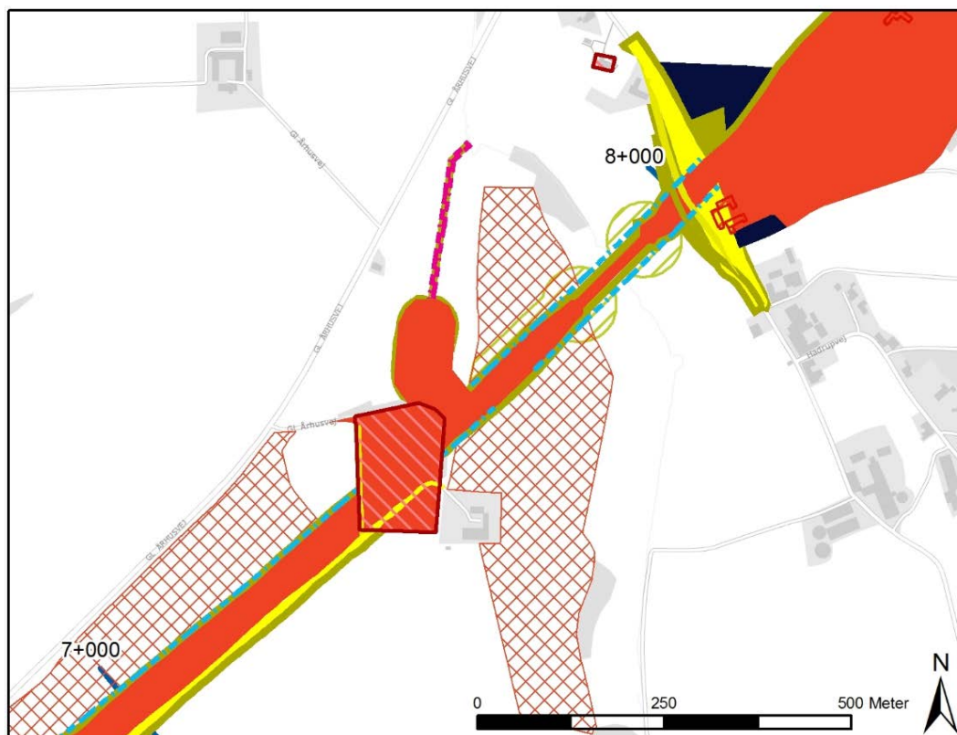
Figur 4. Anlægsarbejde på lokalitet 609-00001 ved Vestlig linjeføring. Rød med striber = V2, mørk rød er permanent eksproprierede arealer til banen, mens olivengrøn er midlertidige arbejdsarealer. Gul er kommende offentlig vej.
