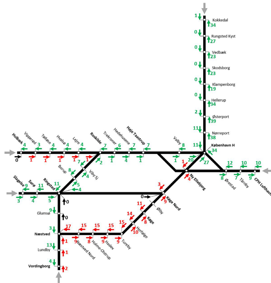
Figur 19: Effekt på middelforsinkelse ved at ombygge til driftsparation bortset fra effekt ved at undlade togvendinger til Københavns Lufthavn (sekunder pr passagerankomst på hver station). Input til samfundsøkonomi.
