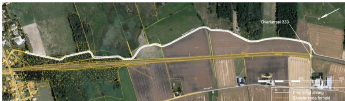
Figur 6.1.13. Parallelvej i Stevnstrup som erstatningsvej til overkørsel 333.
