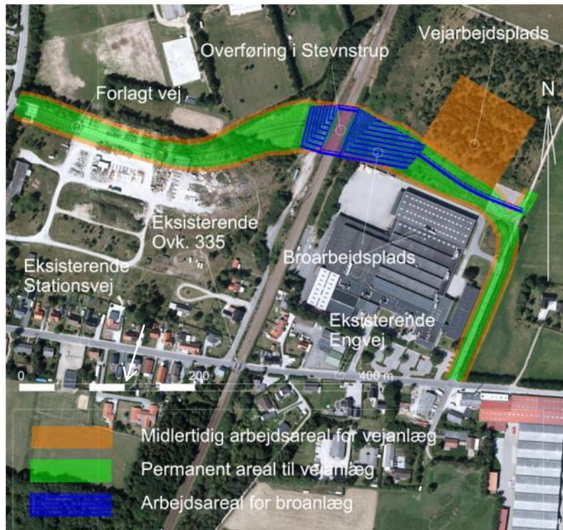
Figur 9.1.4. Bro 20980, Overføring i Stevnstrup, Oversigtsplan.
