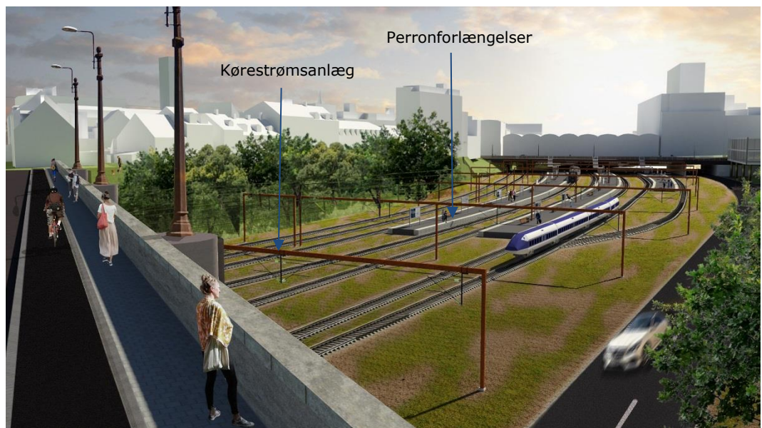
Figur 9 Det kommende kørestrømsanlæg set fra Frederiks Allé, view 2.
