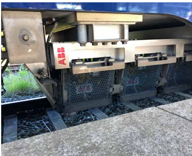
Figur 8: Batteripakke monteret under toget. Foto: Trafikstyrelsen
